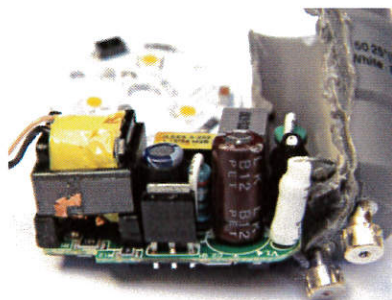
Thermische Überhitzung eines LED-Spots [Fas16a]
